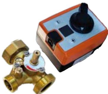
**Art. T.095 - Régulateur de température modulant intégré dans le servomoteur complet avec vanne mélangeuse 3 voies en laiton et sonde de température. Vanne mix incluant une dérivation et raccordement pour pompe. Plage de régulation 1°-100°C - Temps d'ouverture-fermeture réglable 50-150" - Sens d'ouverture et de fermeture paramétrable - Mode de chauffage ou de refroidissement paramétrable.**
